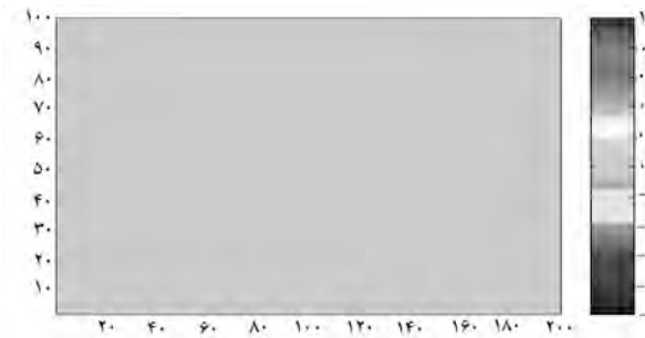
شکل ۶. نتیجه‌ی تست صفر: محورهای افقی و قائم نشان‌دهنده‌ی طول و عرض کف اقیانوس برحسب ۲ کیلومتر هستند. مقیاس رنگی نشان‌دهنده‌ی مقدار تغییر شکل کف اقیانوس برحسب متر است.
